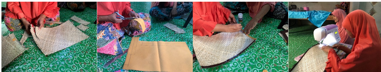
รูปที่ 9 แสดงวิธีการตัดเย็บริมผลิตภัณฑ์ชุดรองจานด้วยวัตถุดิบหนัง
