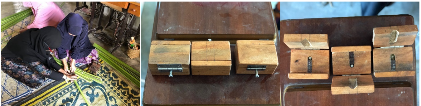
รูปที่ 3 แสดงวิธีการกรีดเส้นเตยหนามป่าตามขนาดและอุปกรณ์ตลับกรีดเส้นเตยหนามทั้ง 3 ขนาด
