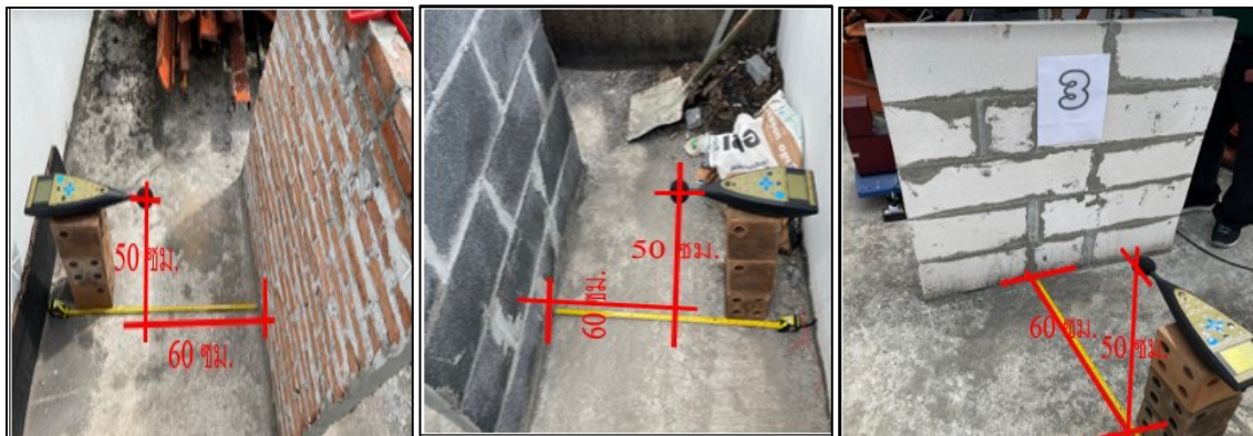
ภาพที่ 2 กำหนดระยะห่างระหว่างไมโครโฟนตรวจวัดกับผนังอิฐทั้ง 3 ชนิด ก่อนฉาบ ที่ 60 เซนติเมตร และสูงจากพื้น 50 เซนติเมตร
