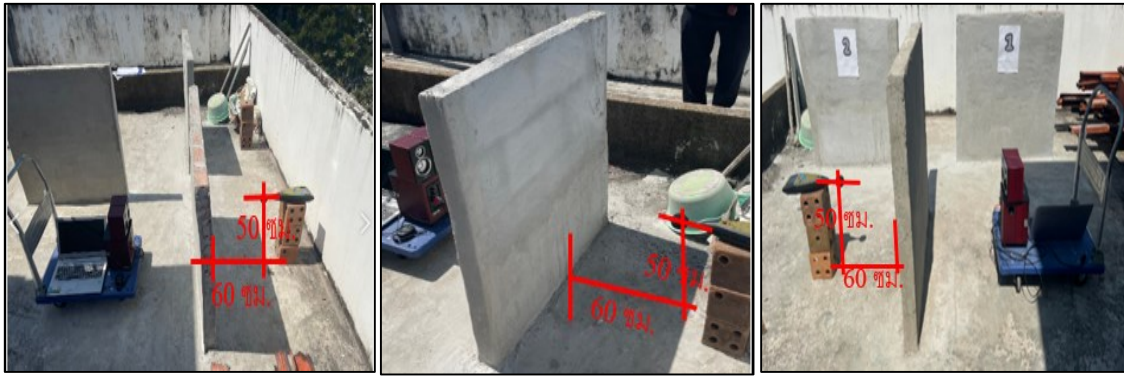
ภาพที่ 3 กำหนดระยะห่างระหว่างอุปกรณ์ตรวจวัดกับผนังอิฐทั้ง 3 ชนิด ที่ฉาบแล้ว ที่ 60 เซนติเมตร และไมโครโฟนให้สูงจากพื้น 50 เซนติเมตร
