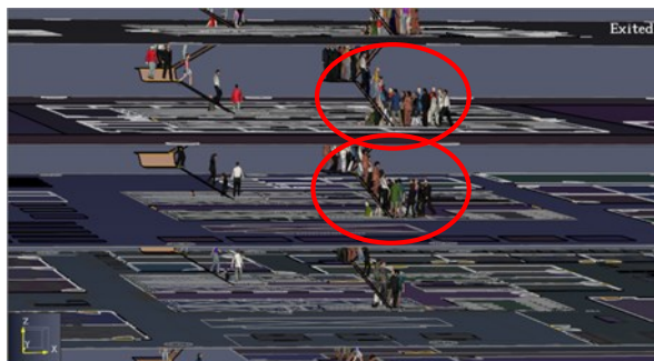
ภาพที่ 8 แสดงผลปริมาณความแออัดที่บันไดหนีไฟ 2 ดังแสดงในบริเวณที่วงกลม
