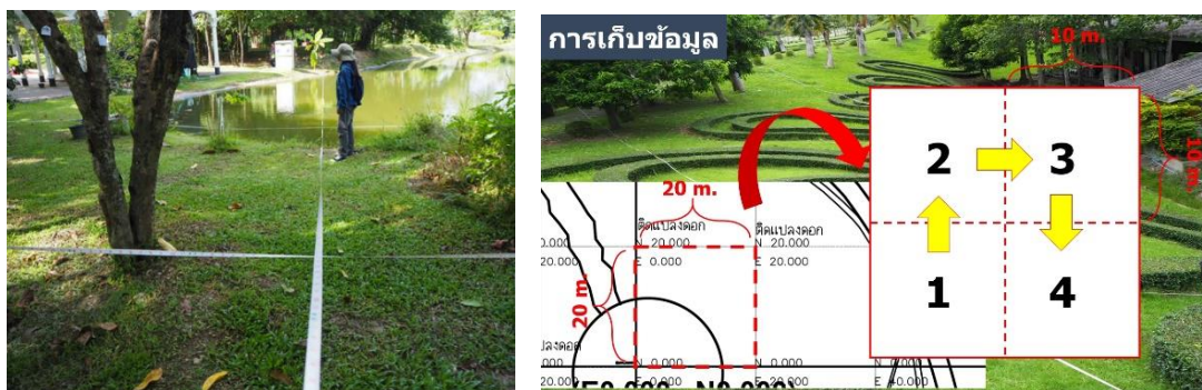
ภาพที่ 3 การรังวัดพื้นที่เพื่อกำหนดขอบเขตแปลงขนาด 20 x 20 เมตร
