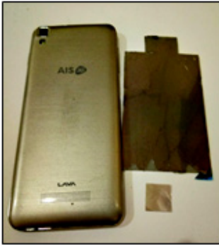
รูปที่ 1 ฟิล์มโพลาริซซ์ที่ได้จาก สมาร์ทโฟนรุ่นเก่า
