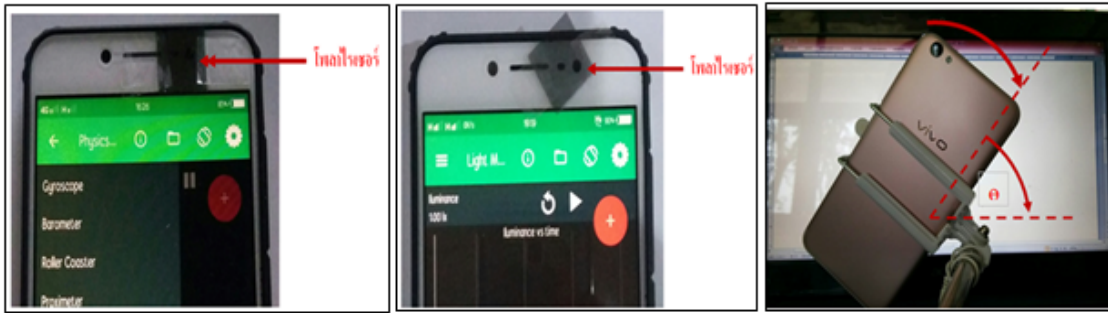
รูปที่ 5 फिल्मโพลาริซตั้งบน เซ็นเซอร์ของสมาร์ทโฟน Vivo V5s
